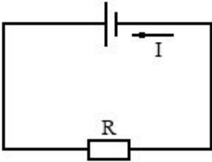
Рассмотрим простейшую полную (замкнутую) цепь, состоящую из источника тока и резистора сопротивлением  $R$ .
