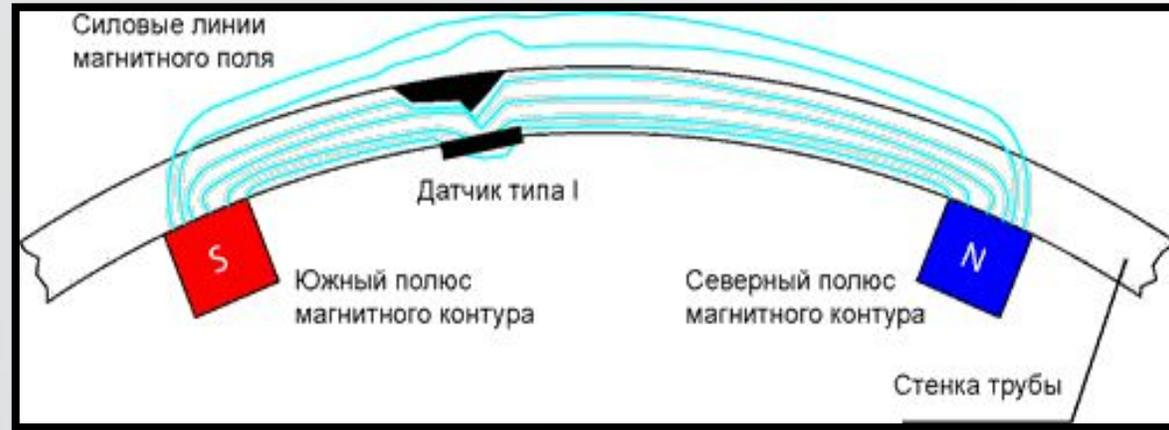
Принцип поперечного намагничивания трубопровода и регистрации сигналов датчиками типа I (TFI)
