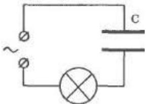
Постоянный ток не может идти по цепи, содержащей конденсатор. При этом цепь оказывается разомкнутой, так как обкладки конденсатора разделены диэлектриком.
