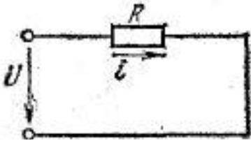
Ток и напряжение изменяются по одному и тому же закону. Одновременно достигают своих максимальных значений и проходят через нуль.
