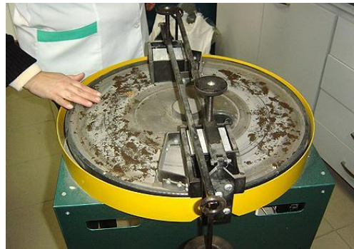
Рис. 3.7. Лабораторный прибор (круг на истирание) для определения истираемости строительных материалов.
