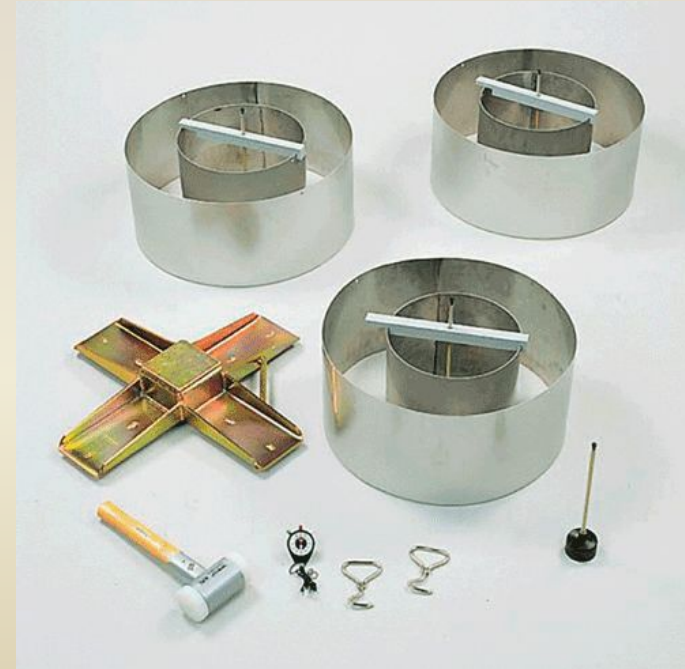
Рис. 15. Двухкольцевой инфильтрометр для замера фильтрующей способности грунта по ГОСТ 23278
