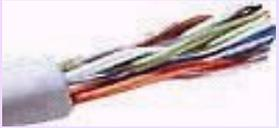
**витая пара** состоит из двух изолированных проводов, свитых между собой; скручивание проводов уменьшает влияние внешних электромагнитных полей на передаваемые сигналы; самый дешёвый тип кабеля, скорость передачи информации 0,25–1 Мбит/сек;
