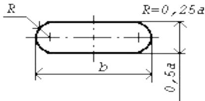
Начало, конец, прерывание процесса обработки данных или выполнения программы
