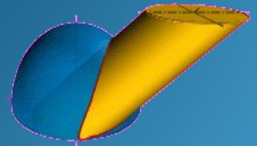
В некоторых случаях при построении линии пересечения поверхностей целесообразно в качестве вспомогательных поверхностей использовать не плоскости, а сферы. Их применение основано на свойстве соосных поверхностей вращения пересекаться по окружностям. Соосными называются поверхности вращения, имеющие общую ось
