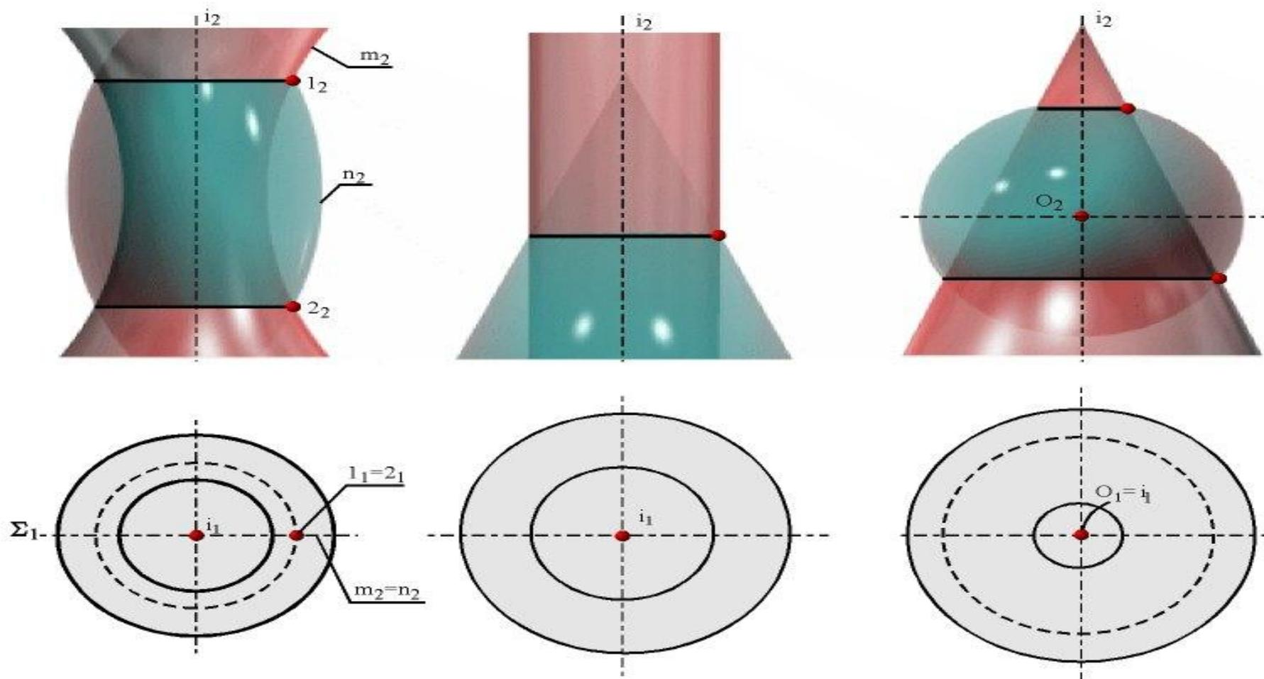
Если в качестве вспомогательных секущих поверхностей используются плоскости, то способ построения называют **способом вспомогательных плоскостей**.
