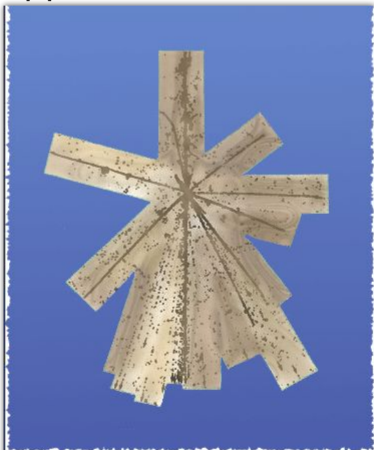
По следам частиц в фотоэмульсионном слое можно судить о видах частиц, содержащихся в пучке.
