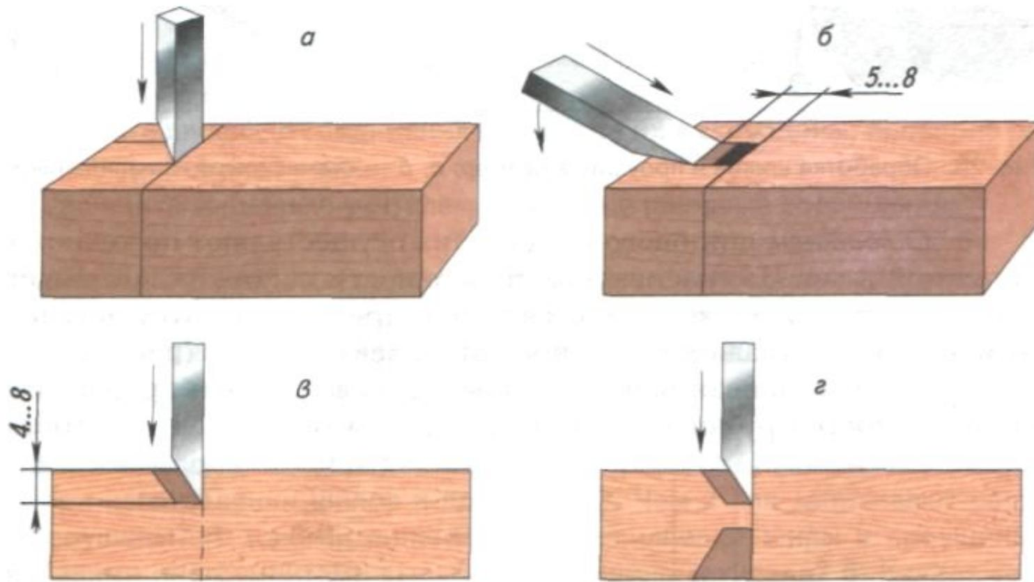
**а – поперечное надрубание дна; б- наклонное вырубание; в – углубление дна; г – долбление с противоположной стороны**
