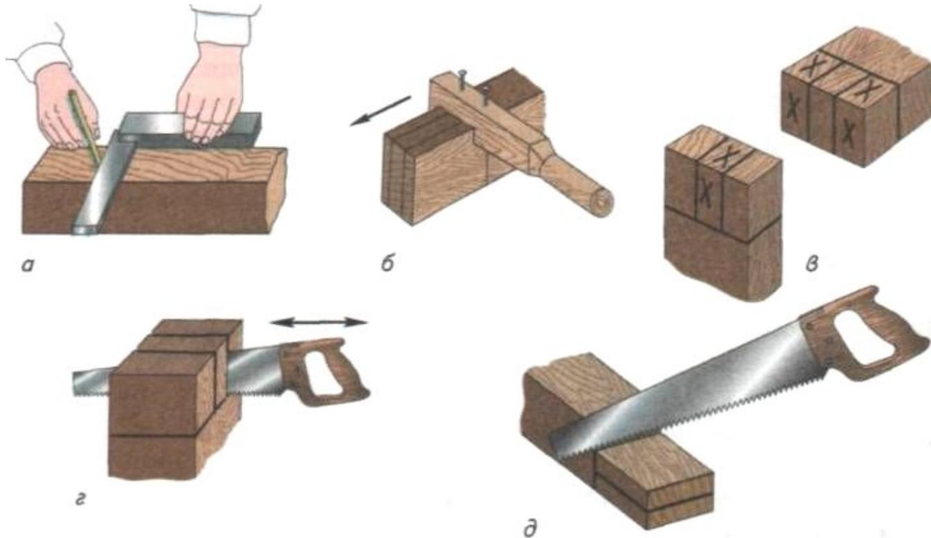
**а – поперечная разметка; б – продольная разметка; в – пометка удаляемых частей заготовки; г – продольное выпиливание шипа и проушины; д – поперечное выпиливание шипов**
