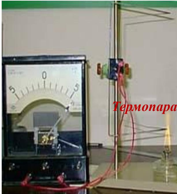
*Термоэлемент (термопара)* - две проволоки из разных металлов необходимо спаять с одного края, затем нагреть место спая, то в них возникает ток. Заряды разделяются при нагревании спая.
