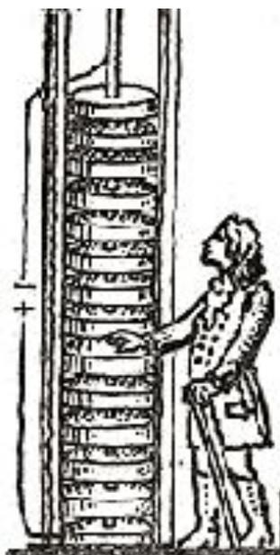
Его первый источник тока — «вольтов столб» был построен в точном соответствии с его теорией «металлического» электричества. Вольт положил друг на друга попеременно несколько десятков небольших цинковых и серебряных кружочков, проложив меж ними бумагу, смоченную подсоленной водой.
