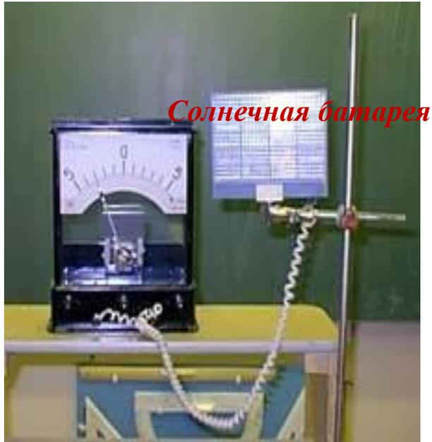
**Фотоэлемент.** При освещении некоторых веществ светом в них появляется ток, световая энергия превращается в электрическую. В данном приборе заряды разделяются под действием света. Из фотоэлементов составлены солнечные батареи. Применяются в солнечных батареях, световых датчиках, калькуляторах, видеокамерах.
