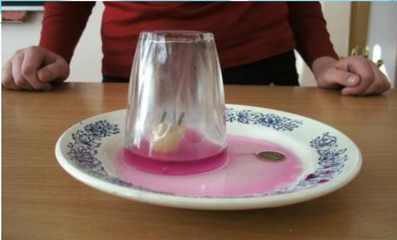
● При нагревании часть воздуха вышла из стакана. Давление в нем уменьшилось. Под действием атмосферного давления вода вдавилась в банку.
