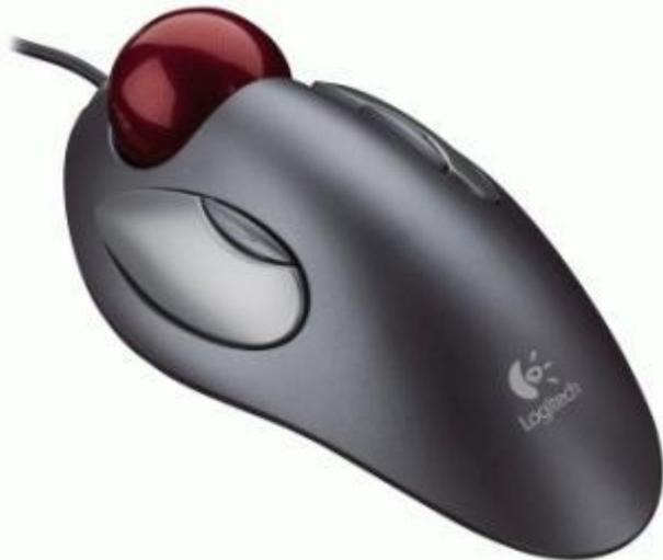
Для ввода графической информации и для работы с графическим интерфейсом используются координатные устройства ввода информации – манипуляторы (мышь, трекбол), сенсорные панели, графические планшеты. В настоящее время широкое распространение получили оптические мыши, в которых источник света, размещенный внутри мыши, освещает поверхность, а отраженный свет фиксируется и преобразуется в перемещение указателя мыши на экране.
