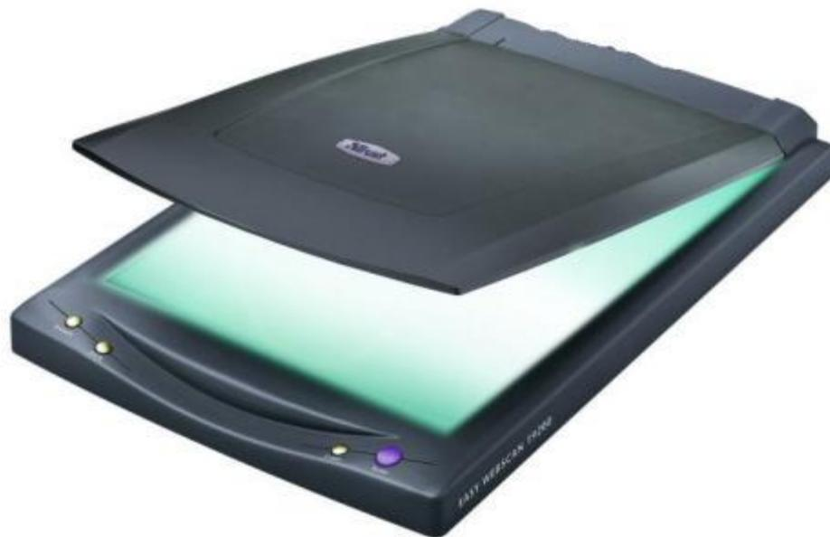
Для оптического ввода в компьютер и преобразования в компьютерную форму изображений, фотографий, рисунков, слайдов), а также текстовых документов используется сканер. Сканируемое изображение последовательно освещается светом источников, размещенных на движущейся линейке внутри сканера, а отраженный свет преобразуется в изображение в компьютерном формате.
