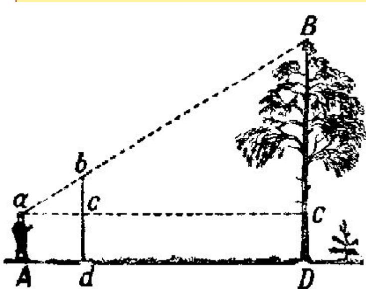
На основании подобия  $\Delta abc$  и  $\Delta aBC$  вычислить  $BC$  из пропорции  $BC: bc = aC: ac$ . Расстояния  $bc$ ,  $aC$  легко измерить. К длине  $BC$  нужно прибавить расстояние  $CD$ , чтобы узнать высоту дерева.
