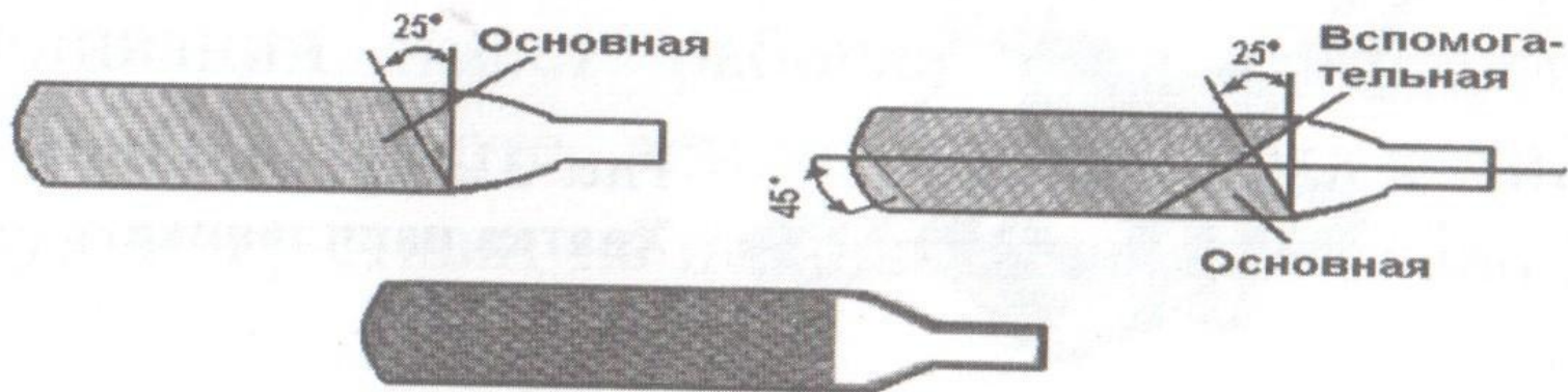
Рис. 30. Виды насечек напильника:
