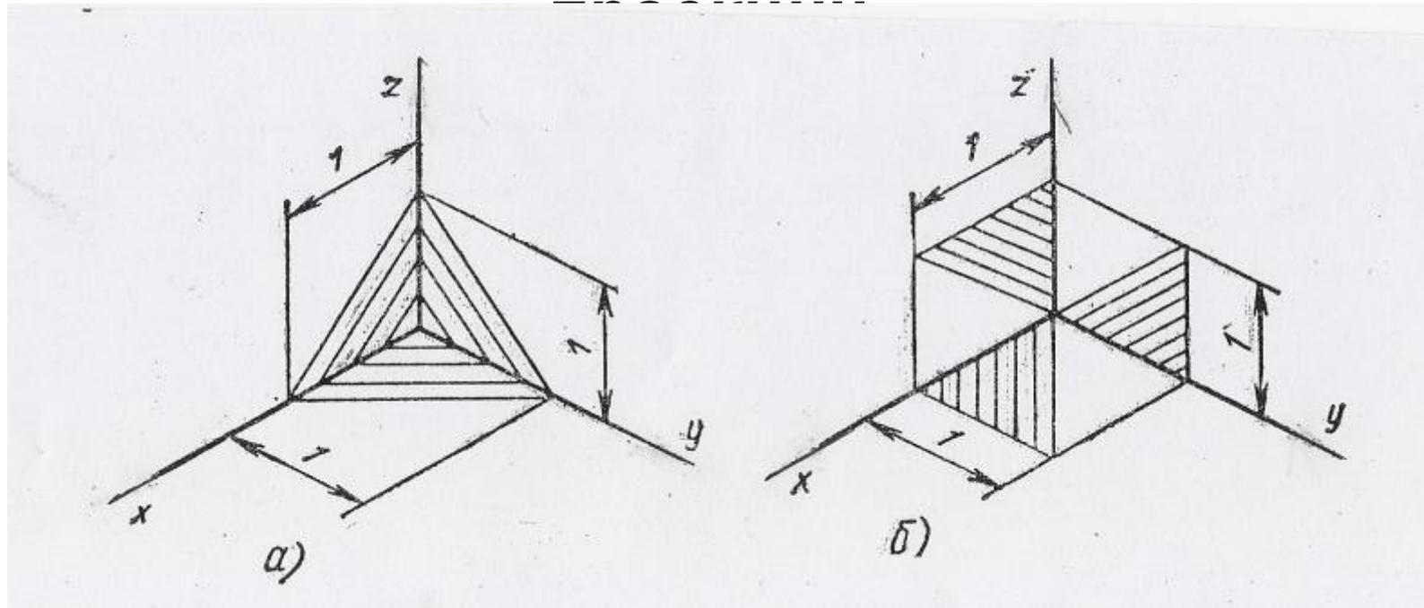
Линии штриховки сечений в аксонометрических проекциях-изометрической проекции наносят параллельно одной из диагоналей проекций квадратов, лежащих в соответствующих координатных плоскостях, стороны которых параллельны аксонометрическим осям.
