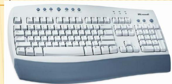
Кроме алфавитно-цифровых клавиш клавиатура обычно имеет **12 функциональных клавиш**, расположенных вдоль верхнего края. Функциональные клавиши могут программироваться пользователем. Например, во многих программах для получения помощи (подсказки) задействована клавиша **F1**, а для выхода из программы — клавиша **F10**.
