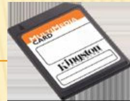
**Flash-память** – это энергонезависимый тип памяти, позволяющий записывать и хранить информацию на микросхемах. Flash-память обеспечивает высокую сохранность данных, высокую скорость записи и считывания информации при небольших размерах. Устройства на основе flash-памяти не имеют в своём составе движущихся частей, что обеспечивает высокую сохранность данных при их использовании в мобильных устройствах
