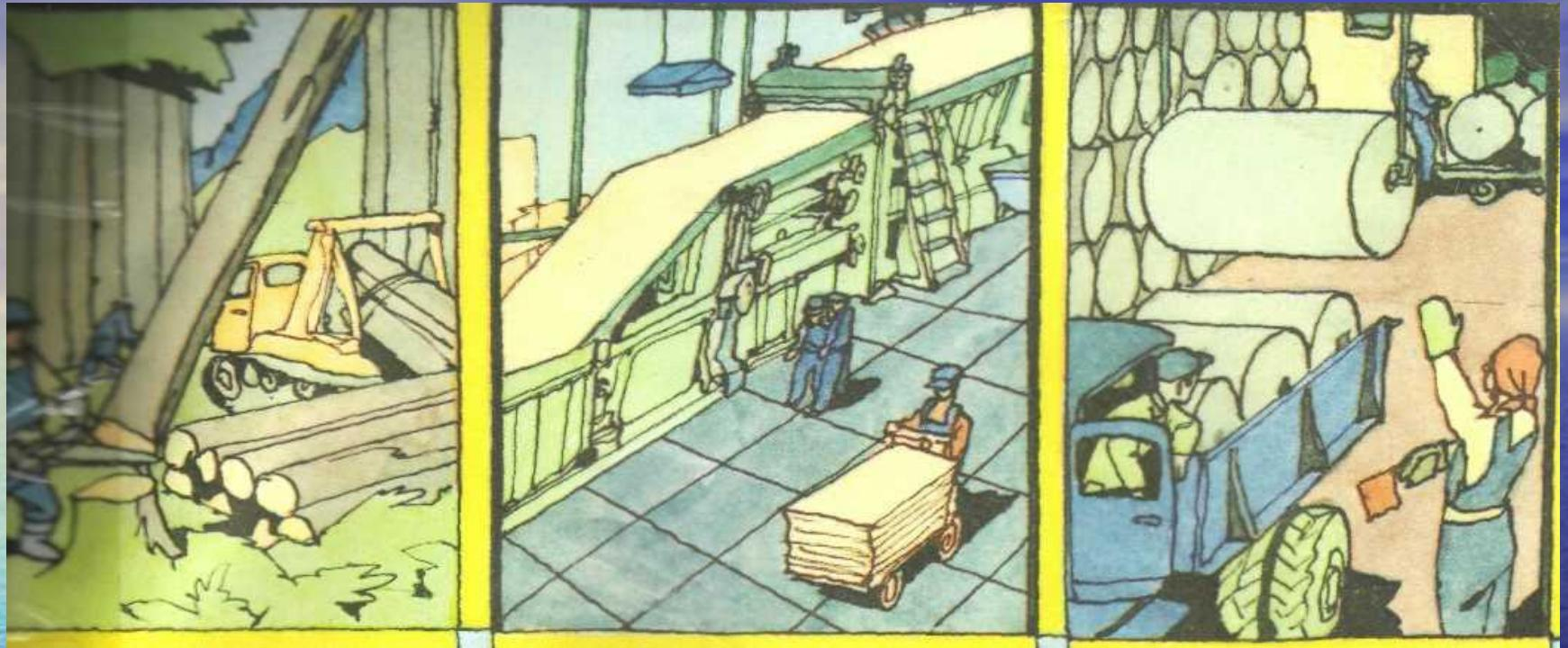
**Машины снимают с брёвен кору, разрезают на чурбашки и размалывают в мелкие щепки. Щепки подолгу варят в огромных котлах, к ним добавляют нужные вещества, жидкость становится белой, и тогда она попадает на бумагоделательную машину.**
