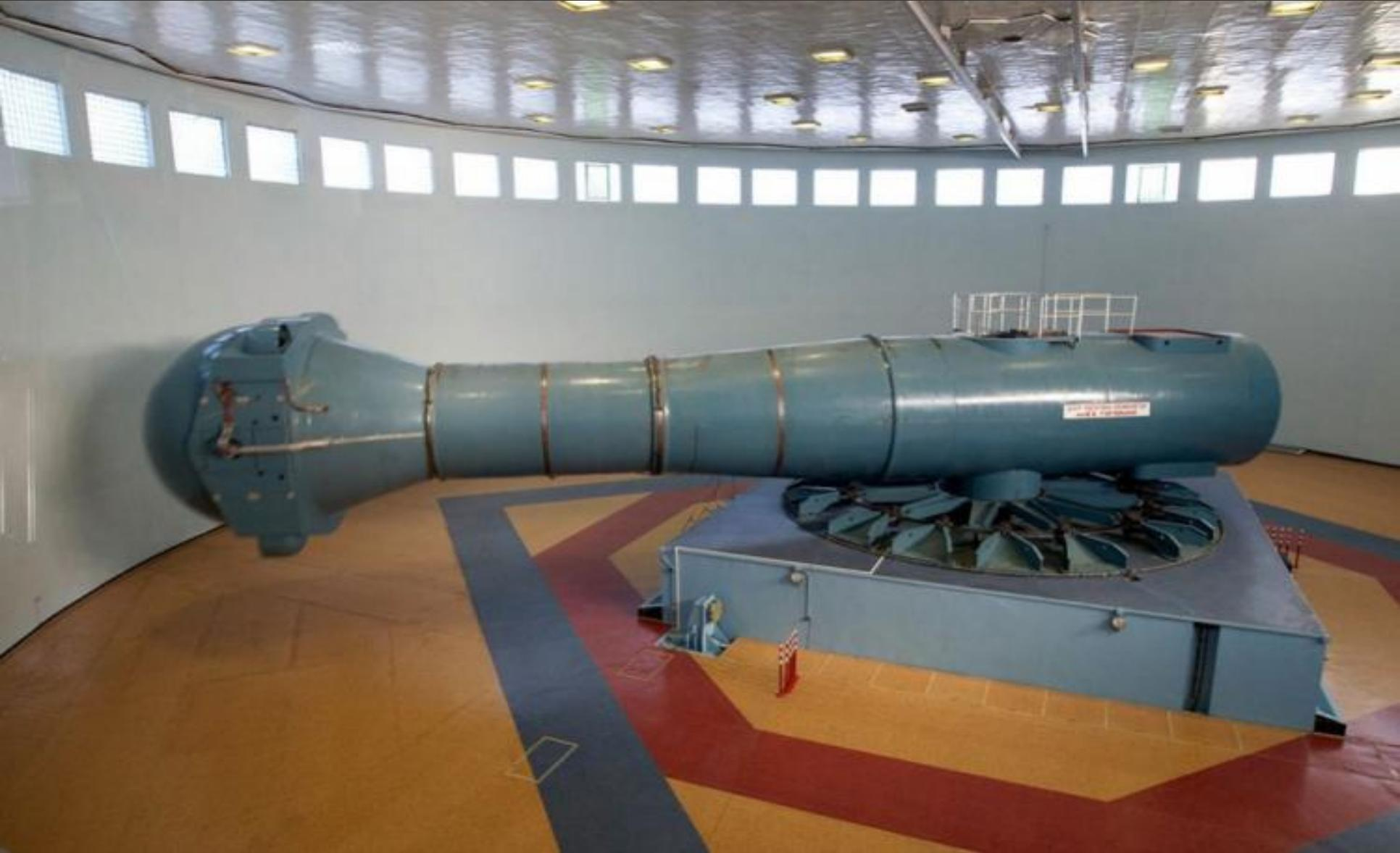
Для тренировок космонавтов используют тренажер – центрифугу. В этой огромной, 18-метровой кегле создаются перегрузки, которые космонавт испытывает во время полета. Сама она вращается по кругу, голова ее тоже вращается, внутри головы вращается кабина, а внутри кабины вращается кресло с космонавтом.
