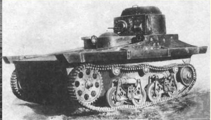
Т-37А - советский малый плавающий танк. Для обеспечения плавучести танк был оснащен дополнительными поплатками, размещенными вдоль бортов корпуса. Развивал скорость на суше до 40 км/ч, а на плаву - до 6 км/ч.
