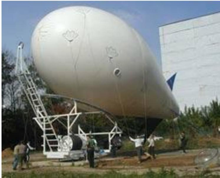
**В России в 2001 г. был произведен запуск аэростатного комплекса «БАРС». Он включал причальное устройство, радиостанцию и привязной аэростат. Эта система **обеспечивала доступ в Интернет** для школ Москвы.**
