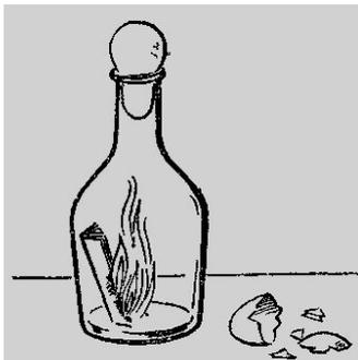
**Пламя нагревает воздух в бутылке и часть его выходит наружу. Когда бутылку закрывают яйцом, воздух в ней охлаждается, давление его падает и внешнее атмосферное давление загоняет яйцо в бутылку**
