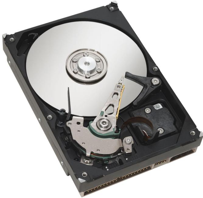
**Жесткий диск** – устройство для долговременного хранения информации, используемой при работе компьютера.
