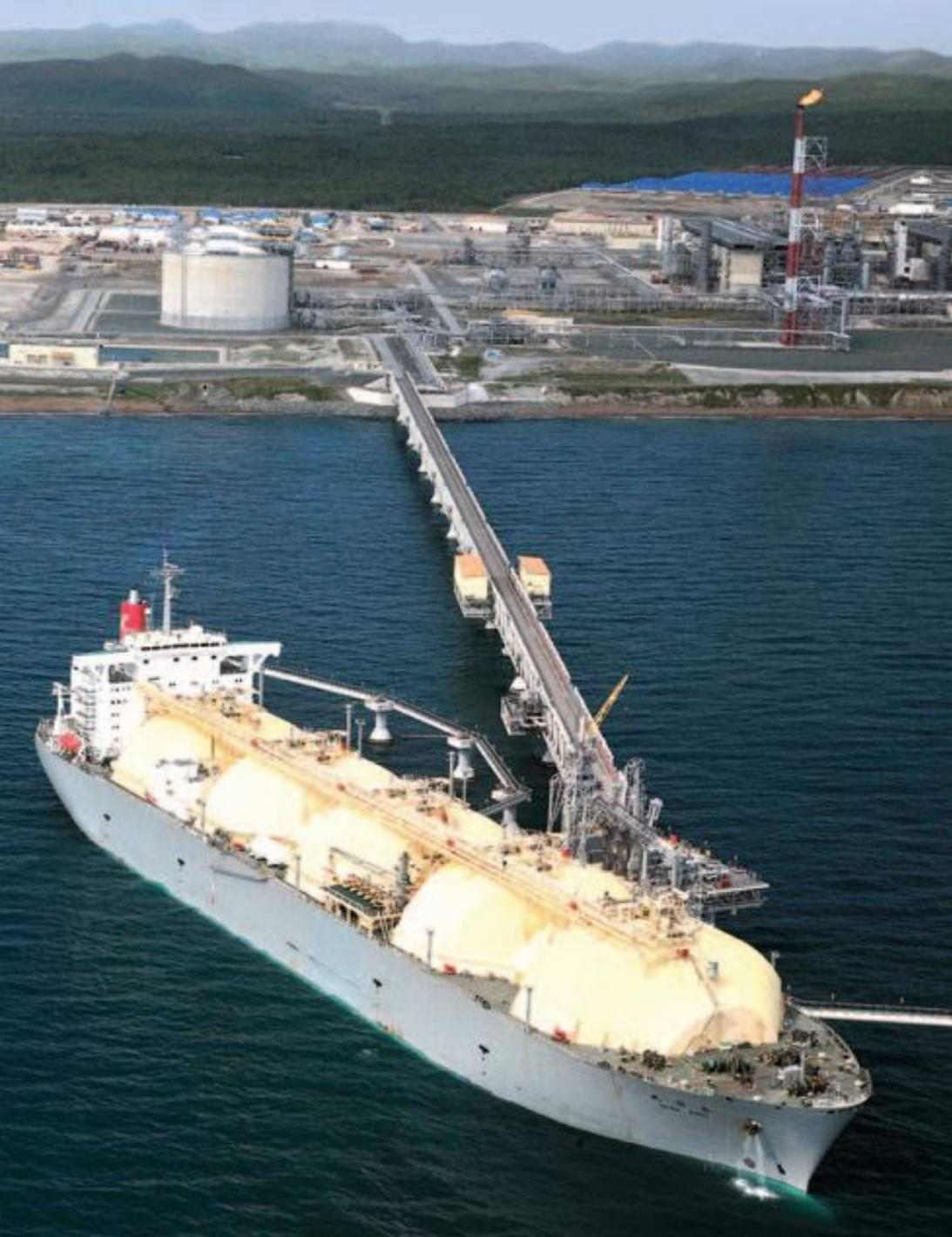
Отгрузка сжиженного газа через специальный причал длиной **805** метров. Он оборудован четырьмя рукавами.
