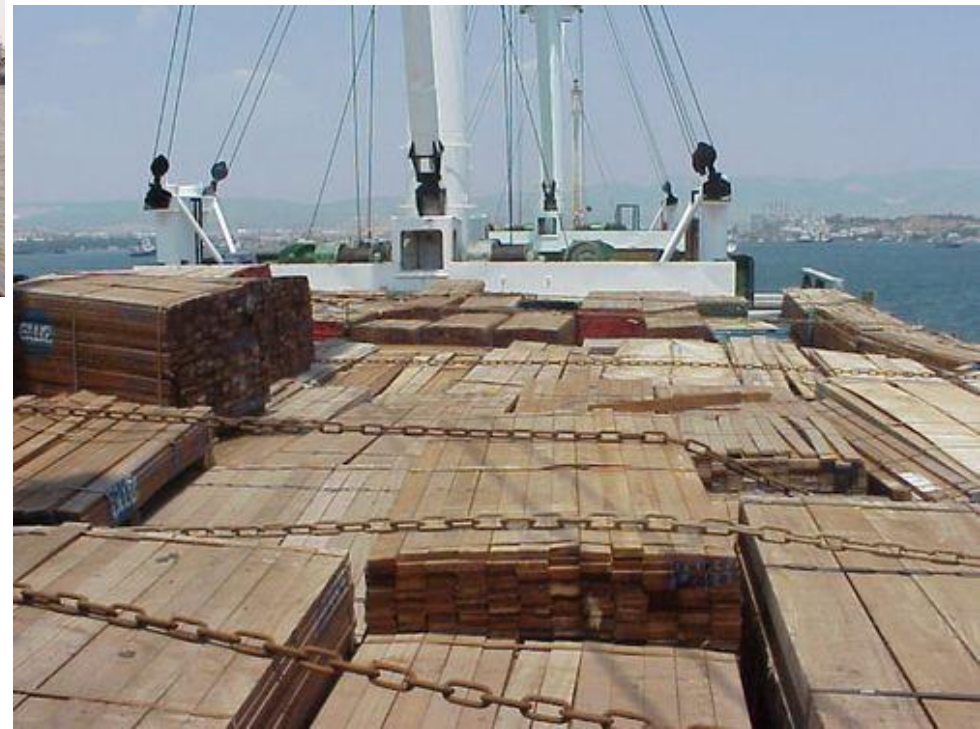
Размещение и крепление палубного груза
