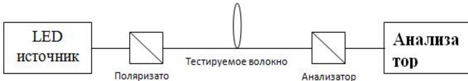
Схема измерения PMD анализатором оптического спектра
