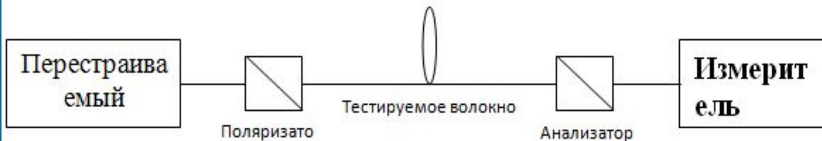
Схема измерения PMD измерителем мощности
