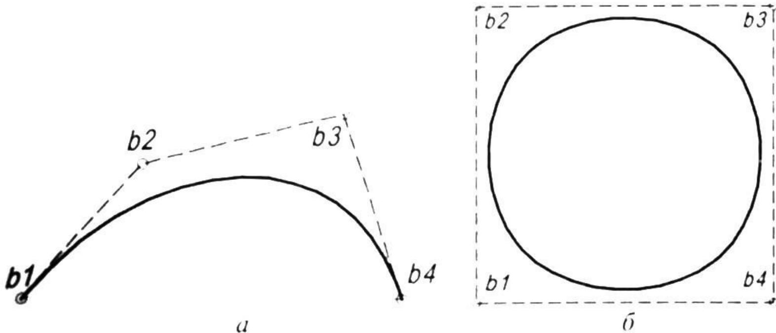
а – кривая Безье и вершины определяющего многоугольника,
