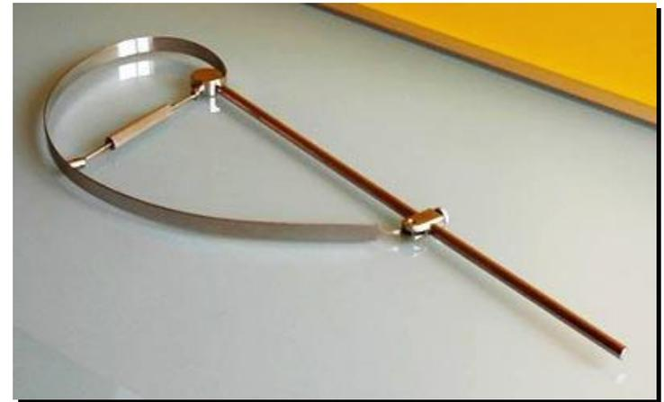
*а* – физический сплайн (гибкое лекало – полоса металла, используемая для черчения кривых линий); *б* – кубический сплайн, NURBS-кривая
