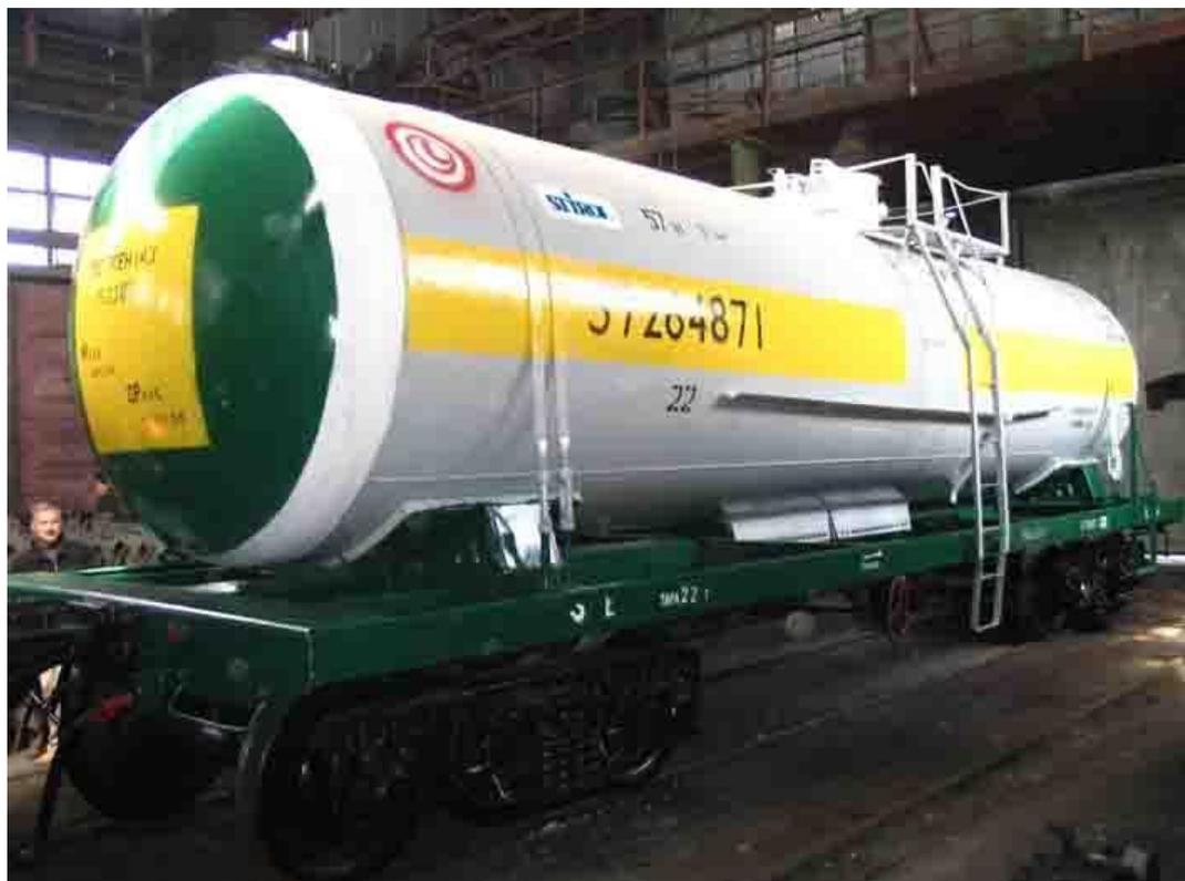
Цистерны для концентрированной азотной кислоты
