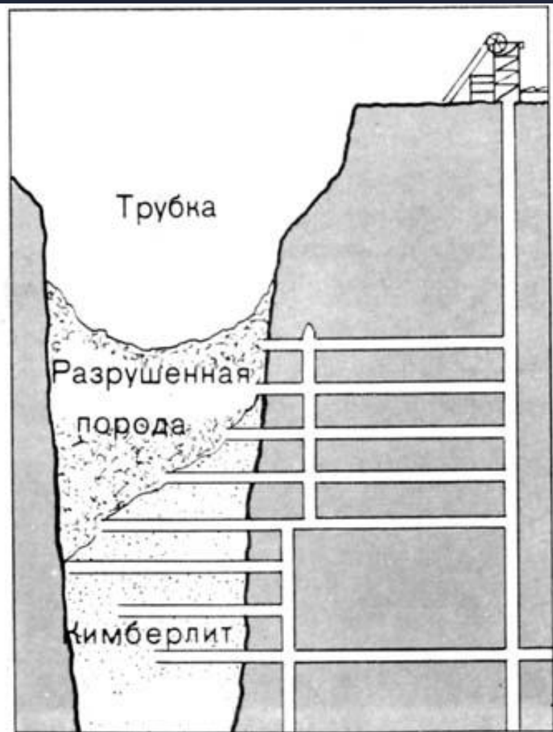
Подземная разработка месторождения в кимберлитовой трубке.
