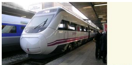
Электропоезд AVE S120 ATPRD (общий вид и колесная пара с переменным положением колес на оси), Испания
