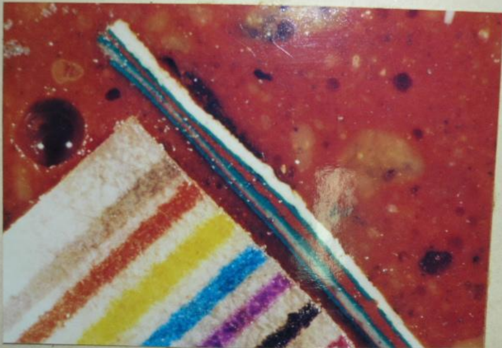
р 2. Поперечный шлиф семислойной конструкции ПСД
