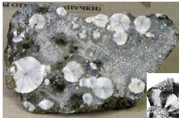
Сферолитовая структура ОГП
