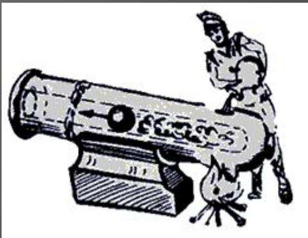
При стрельбе один конец ствола сильно нагревали на огне . Затем в нагретую часть ствола наливали воду. Вода мгновенно испарялась, и пар, расширяясь с силой и грохотом выбрасывал ядро. Ствол пушки представлял собой, как бы цилиндр, по которому, как поршень, скользило ядро.
