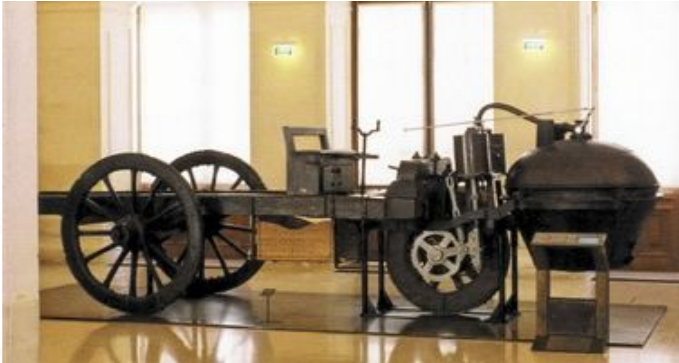
Le fardier, паровая телега военного инженера Николя-Жозефа Кюньо 1769 год
