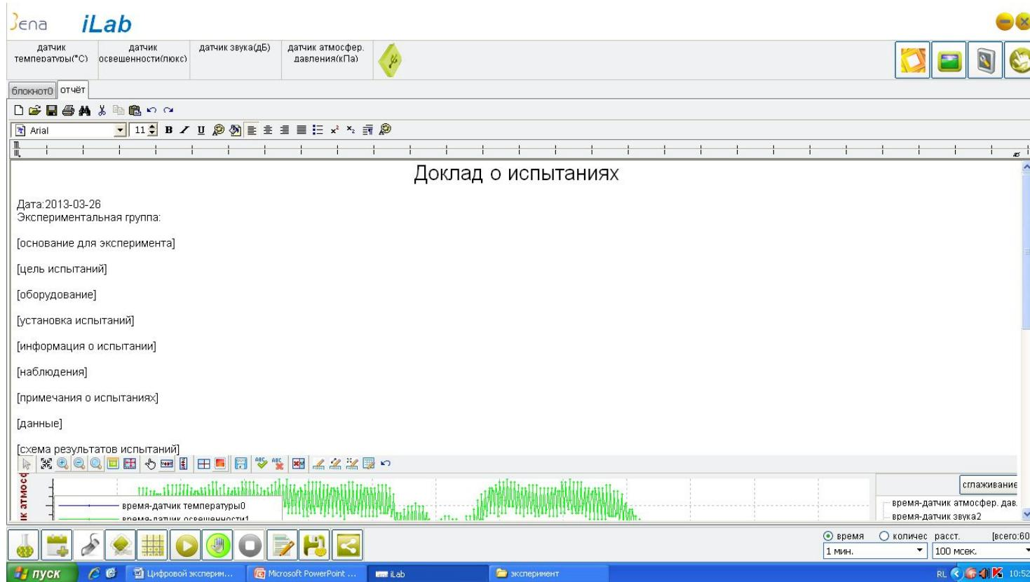
Часть функций сохранения работает. График можно сохранить в формате Jpg , предлагается шаблон заполнения доклада о испытаниях.
