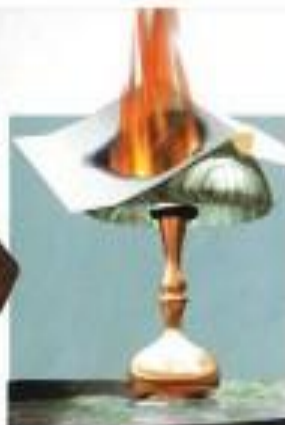
Затмение электролампы горючими материалами (бумагой, тканью)
