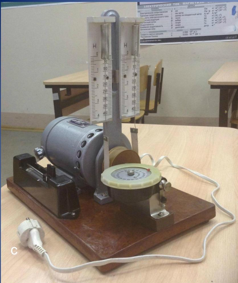
На панели установлены: стойка с продольной прорезью (по стойке перемещаются планка с прикреплёнными к ней двумя динамометрами), держатель со счётчиком числа оборотов, пусковой реостат, закрытый чехлом, и помехоподавляющее устройство.
