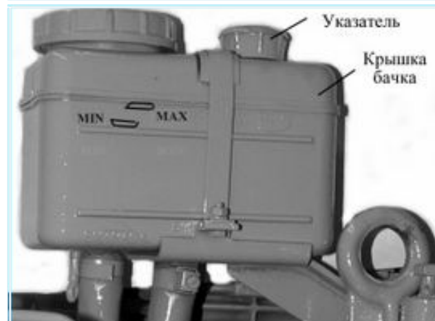
Проверка уровня масла в бачке насоса гидроусилителя модели P1617 фирмы RBL
