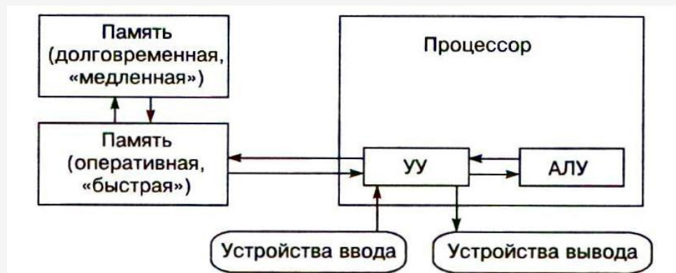
Рис. 1.1.1. Схема взаимодействий устройств компьютера согласно архитектуре фон Неймана Обозначения: УУ – устройство управления; АЛУ – арифметико-логическое устройство
