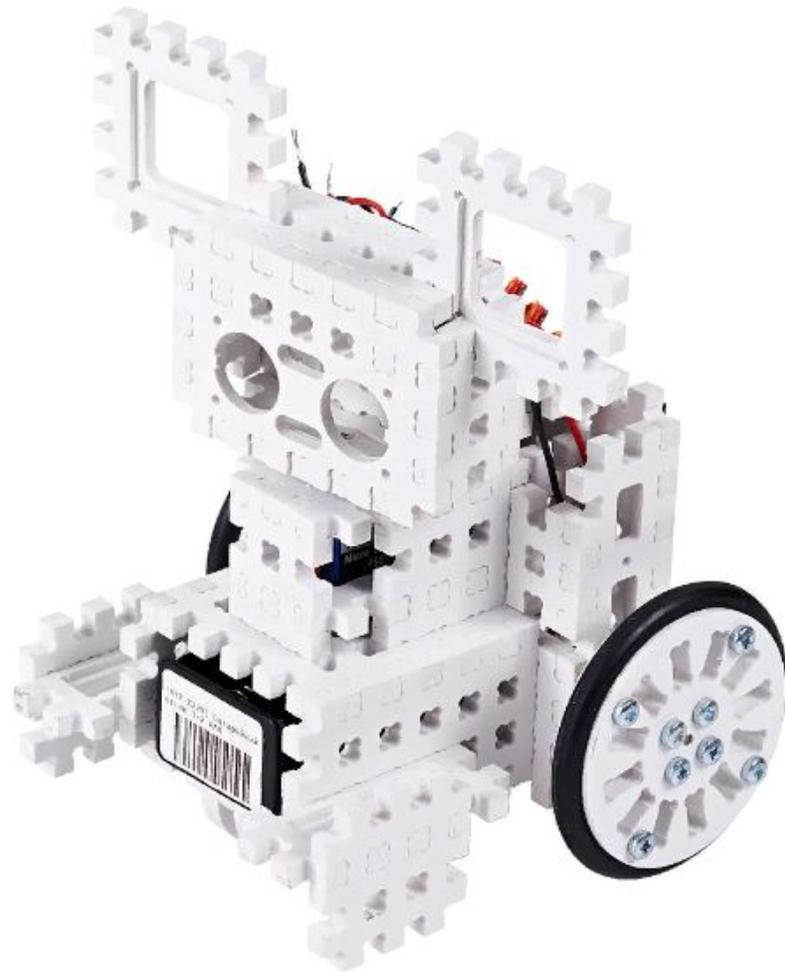
*Первая модель корпуса робота. В дальнейшем, при наличии 3Д-принтера будет произведена проектировка и печать необходимых корпусных элементов для нового более совершенного корпуса.*
