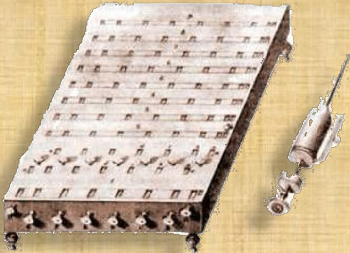
Калькуляторы сейчас стали неотъемлемым атрибутом современной жизни. А вот когда не было калькуляторов, в ходу был **счислитель Куммера**. Сложение и вычитание производилось посредством простейшего передвижения реек.
