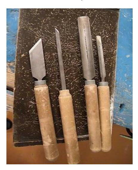
• В комплект токарного станка — СТД — 120 М входит четыре резца (два полукруглых для чернового точения — реер и два в виде плоской стамески — майзель для чистового точения). Для выполнения работ, предусмотренных школьной программой, этого достаточно.
