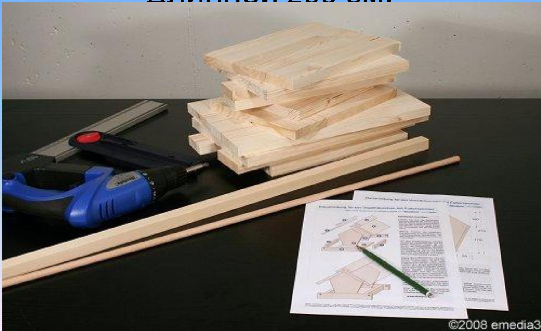
Все детали между собой соединяются при помощи саморезов. Можно использовать деревянные шканты и клей.
