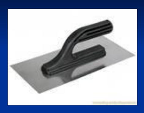
Применяется для заглаживания оштукатуренной поверхности после разравнивания.
