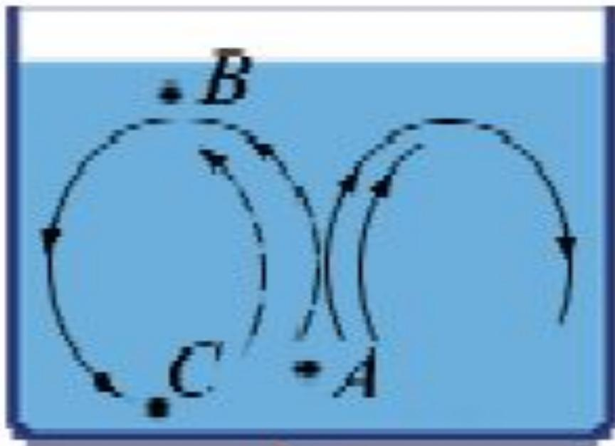
**А** – жидкость нагревается и вследствие уменьшения ее плотности, движется вверх.
