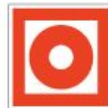
Кнопка включения установок пожарной автоматики
