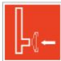
Пожарный сухотрубный стояк
