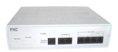
Мультиплексор РМ2 используется в качестве нижнего оборудования для ввода в поток Е1 трафика Ethernet. Это позволяет организовать линию связи необходимой емкости между удаленными сегментами линии связи Ethernet.
