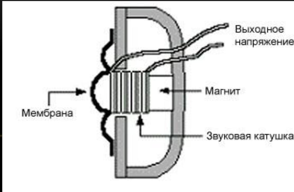
Микрофон преобразует механические колебания в электромагнитные колебания звуковой частоты.
