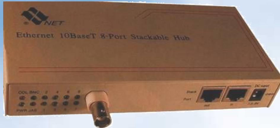
**Концентраторы (HUB или Switch) -** служат для соединения компьютеров в сети.
