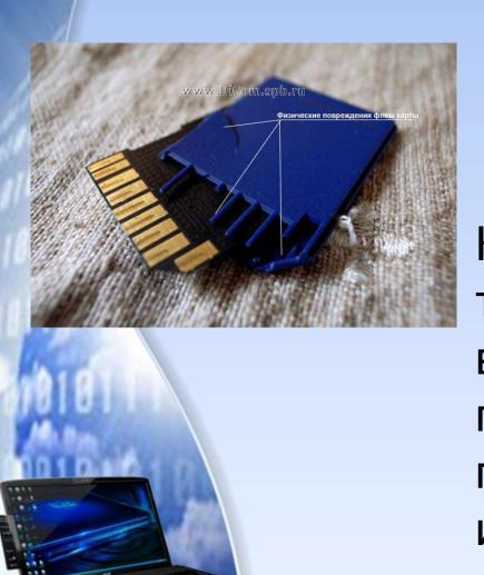
К повреждениям данного типа относятся любые, внешне заметные, повреждения, а именно: повреждения корпуса, изменения геометрии разъема, трещины, деформации и прочее.
